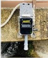
北陸の天候にあった、安価な超音波水位センサーを開発し、その精度を検証・改善（製品化）しました。今後は、国県管轄の河川情報や雨量データと連携付け、より正確な状況把握へつなげます。
